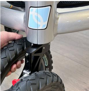
前輪サスペンションを取り付けるには、フレームの前端を持ち上げ、黒いボタンを押して、ホイール アクスルをフレームの下に配置されたアクスル ホールに押し込みます。黒いプッシュ ボタンを放します。
