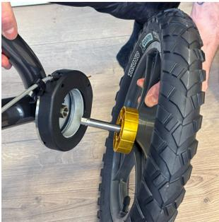
2. 車輪を横に引いたり押ししたりして、正しく取り付けられていることを確認します。
