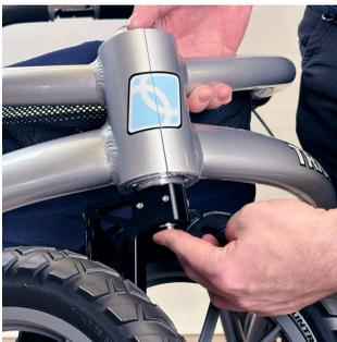
3. 同じ方法で、前輪サスペンションをフレームの前下端に取り付けます。つまり、車軸の下部にある黒いボタンを押し、車軸を下から車軸穴に押し込みます。押しボタンを離します。
