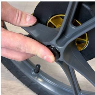
ホイールを取り付けるには、ホイールの中央にある黒いボタンを押して、ホイールの車軸を車軸穴に押し込みます。ホイールが最終位置になったらボタンを放します。
