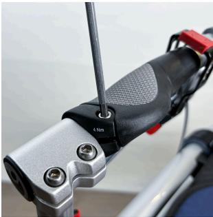
3. グリップの後端にあるネジを4mmの六角レンチで締めます。
