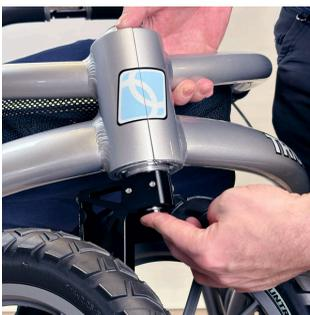
4. フレームを地面から持ち上げ、前輪を下に引いて、前輪がしっかりと固定されていることを確認します。
