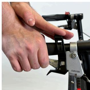
**オプション3:** 両手を使用します。片方の手で上部の赤いパーキングトリガーを後方に引き、もう一方の手でブレーキレバーを引きます。パーキングブレーキがかかっていることを確認します。
