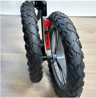
調整ハンドルに簡単にアクセスできるように、前輪を 180 度回転させます。
