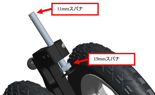
2. QRアクスルの長さを11mmと19mmのスパナで調整します。11mmのスパナでQRアクスルの端を押さえ、回転しないようにします。19mmのスパナでナットを調整します。アクスルがフレームにロックしない場合は、ナットを反時計回りに1/4~1/2回転締めるだけで十分です。
