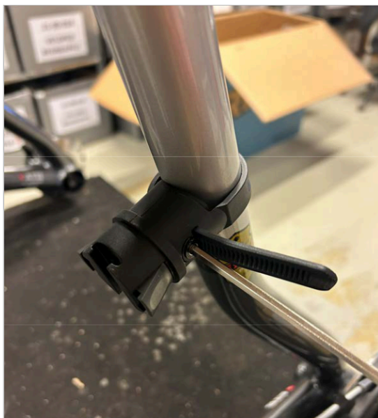
⑥ ストラップがきつく締まるまで、4 mm 六角レンチでネジ/ストラップを締めます。
