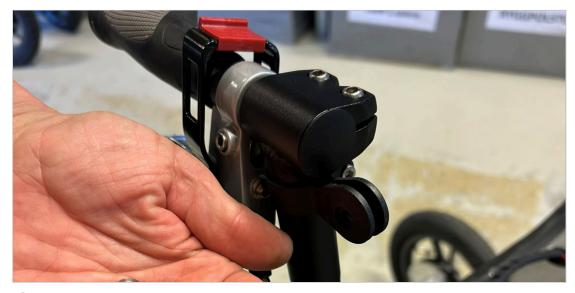
② ネジ、ナット、管状スペーサーを必ず回収してください。
