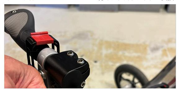
① 3mmの六角レンチを使用して、ストラップを固定しているネジを緩めます。 反対側でも繰り返します。
